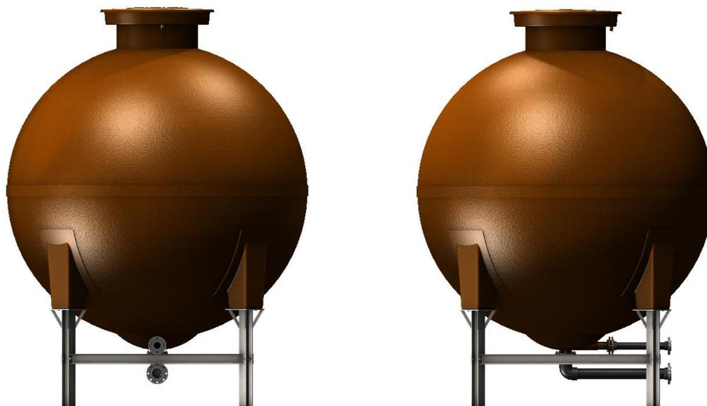
Il serbatoio è realizzato con resine di tipo Isofaliche e Lainer, a contatto con l'acqua, con vetro tipo "C" chimico resistente. La struttura del serbatoio è rinforzata con mat a fili tagliati mediante apposita macchina "taglia e spruzzo" con controllo costante dei reattivi di catalizzazione. I rinforzi impiegati consistono nell'impregnazione di stuoie di vetro puro da 500 gr/mq alternandolo con strati di roving fino a raggiungere uno spessore sufficiente in tutta la parete della semisfera.
